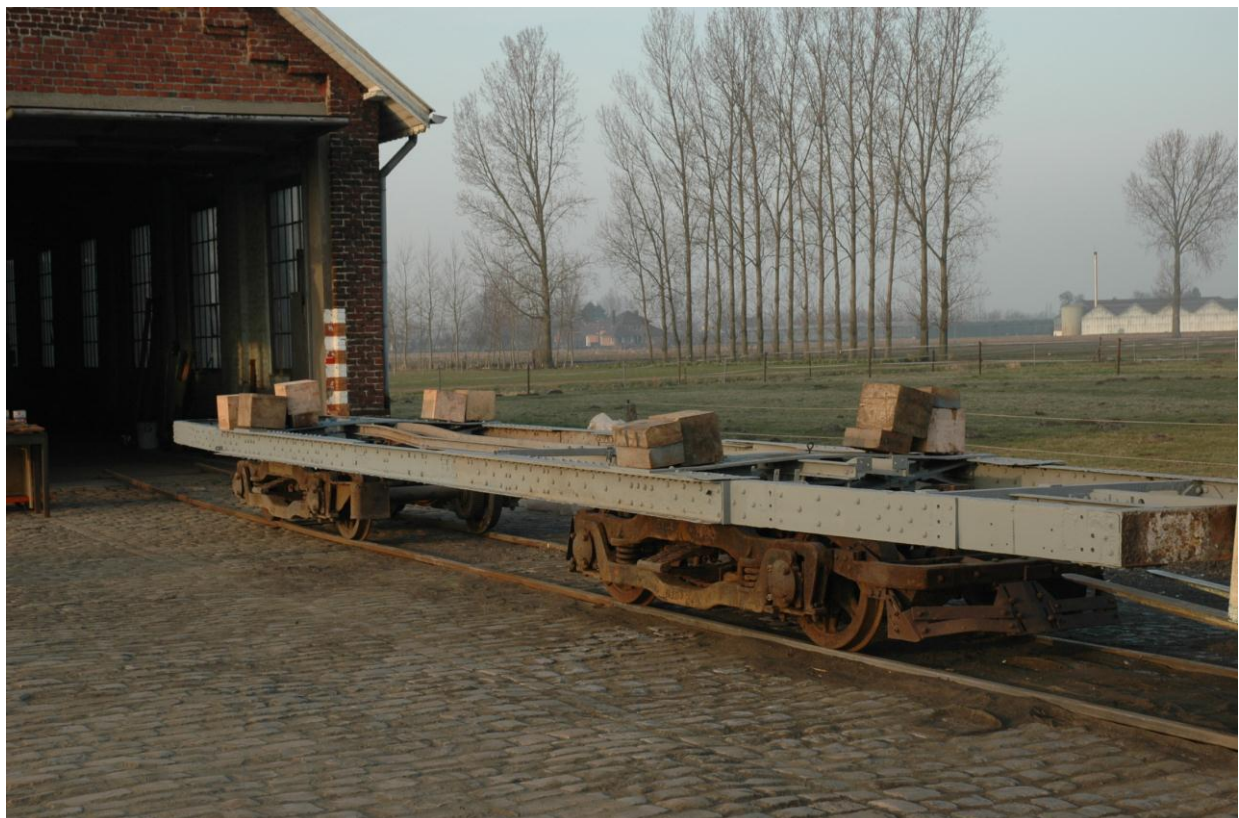
Februari 2009 : het chassis werd onderuit de tram gehaald, buitengesleept, gereinigd, gelast en gelakt...
