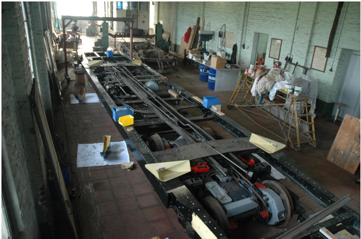
Enkele maanden later : ditzelfde chassis is na lakken in zinkverf, epoxyprimer en zwarte lak terug aangekleed en rust op de gereviseerde draaistellen van type S 9127.
