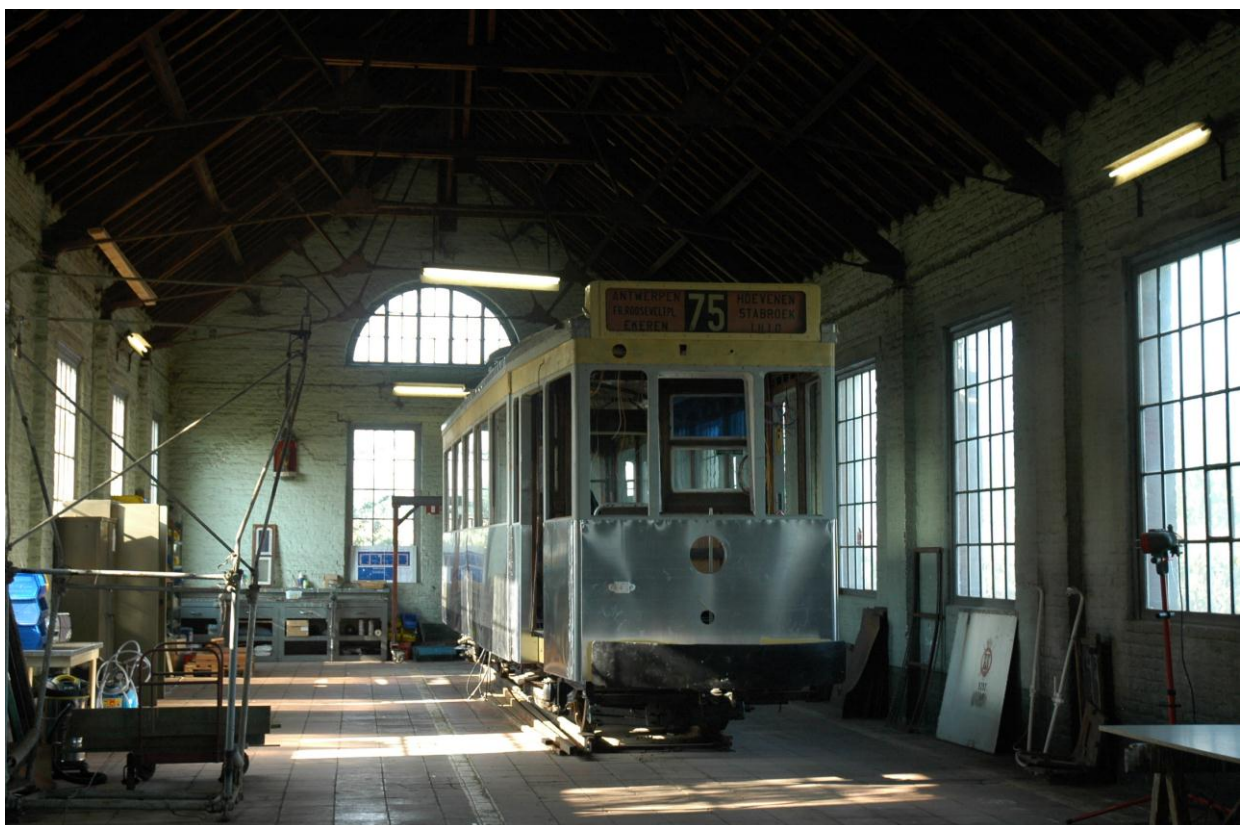
September 2009 : de tram staat inmiddels op zijn volledig gereviseerd chassis, de nieuwe beplating is aangebracht, het monteren en afwerken kan beginnen.
