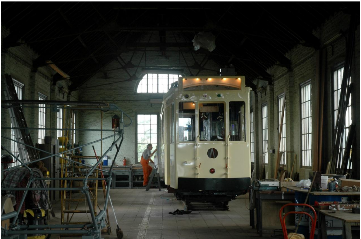
Na een aluminiumprimer, en een laag epoxyprimer, wordt een eerste laag crème verf aangebracht (augustus 2010)
